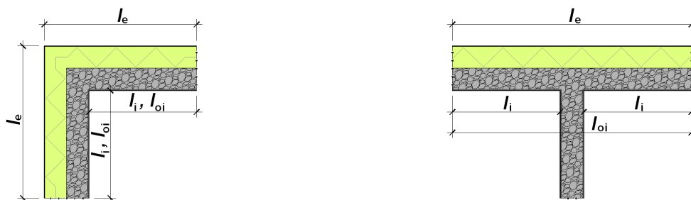
Joonis 3.4 Tarindi geometria määramine välisseinanurga (vasakul) ja välisseina-vaheseina liitekohta (paremal) külmasilla soojuskao arvutamisel.
